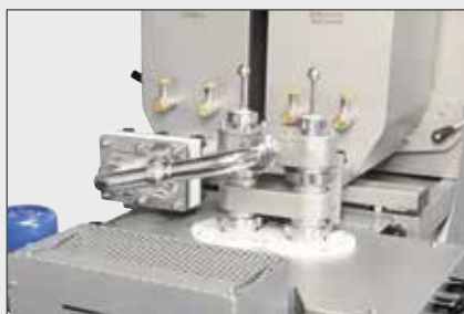
IT | Testata di estrusione a due uscite max Ø 50 mm EN | Extrusion head two rows maximum Ø 50 mm ES | Cabezal de extrusión con dos salidas max Ø 50 mm FR | Tête d'extrusion à deux sorties max Ø 50 mm
