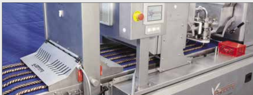
IT | Gruppo taglio ghigliottina/gruppo stampo EN | Cutting unit guillotine/mould unit ES | Unidad corte guillotina FR | Groupe de coupe à guillotine
