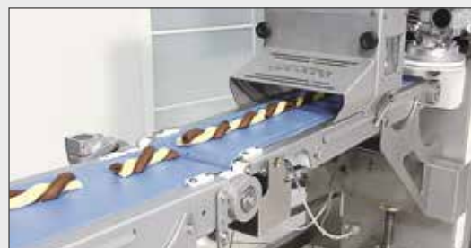
IT | Testata rotativa per prodotto twist EN | Rotative head for twist product ES | Cabezal rotativo para producto trenzado FR | Tête rotative pour produit twist
