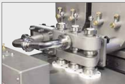
IT | Testata di estrusione a tre uscite max Ø 32 mm. EN | Extrusion head three rows maximum Ø 32 mm. ES | Cabezal de extrusión con tres salidas max Ø 32 mm FR | Tête d'extrusion à trois sorties max Ø 32 mm
